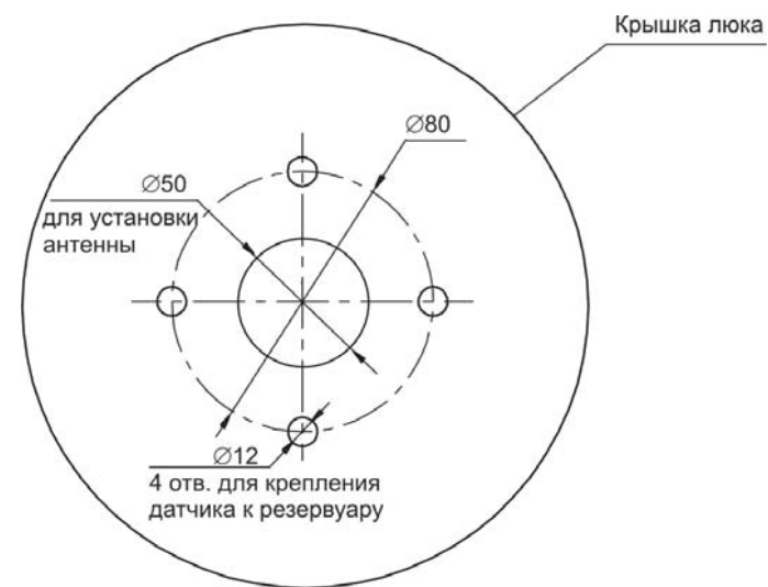
Рисунок 2 – Рекомендуемый вариант посадочного места датчика РДУ1-0(0А, 1, 1А, 2, 2А)
