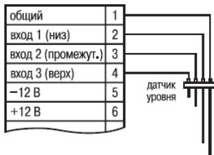
Рис. Б2. Схема подключения кондуктометрических датчиков уровня
