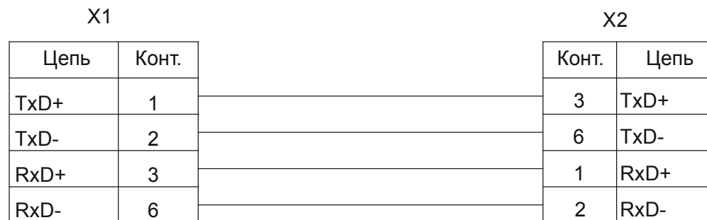
Рисунок D.1 - Схема прямого Ethernet-кабеля для подключения прибора к сетевому коммутатору
